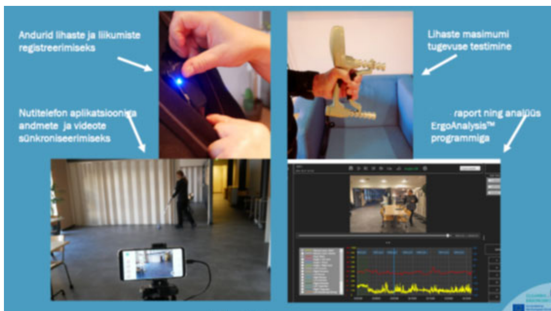
Joonis 9. Mõõteandurite reguleerimine, katse läbiviimine, tulemuste analüüsimine
